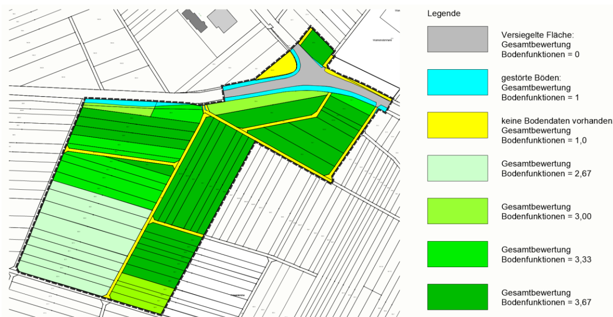
Abb 15. Auswertung der Bodenschätzung nach ALB und ALK, Quelle: LGRB, bearbeitet durch mquadrat
