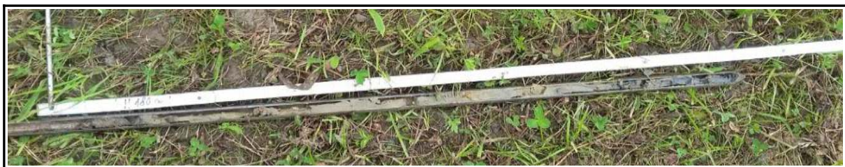
Abbildung 7: Wassergesättigter Boden rund um Bohrpunkt 2 (oben) sowie Bohrprofil von Bohrpunkt 2 (unten). Aufnahmedatum: 04.06.2021.
